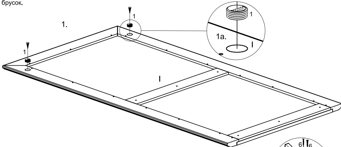
Перевернуть вешалку (1) отверстиями Ø30мм вниз. Закрепить на вешалке (1) крючки (4 и 5) с помощью саморезов (6) (рис. 2 и 2а).
