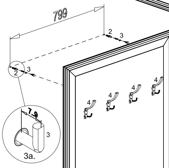
Определить место для установки вешалки согласно дизайн-проекта. Сделать разметку для навески вешалки (рис. 3).
